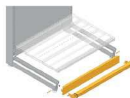
Zoccolo agganciabile con batticarrello in tubo Q32
