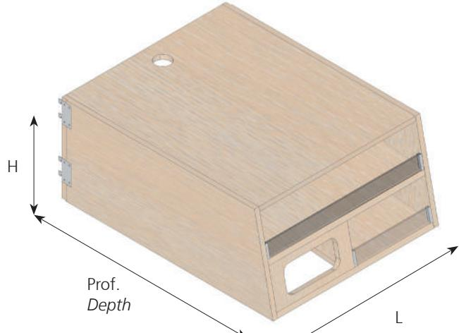
Modulo per lo stoccaggio ed il prelievo di guanti e sacchetti agganciabile alla struttura come modulo inferiore.
